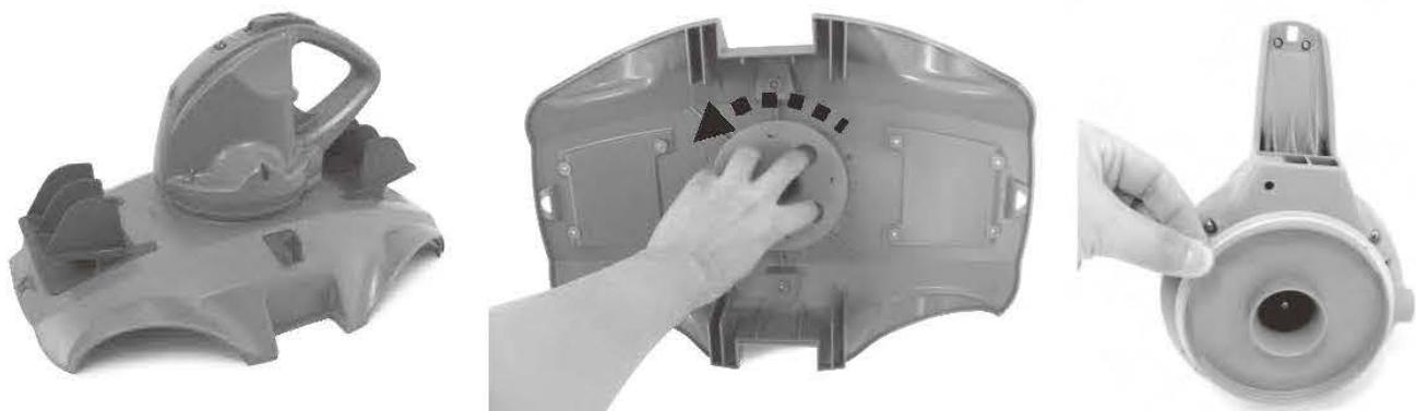
2. Użyć wkrętaka do odkręcenia 4 wkrętów znajdujących się w dolnej części głowicy, aby najpierw zwolnić płytę dolną. Użyć wkrętaka do odkręcenia wszystkich wkrętów podstawy, tak jak pokazano. Wymontować wirnik, a następnie podważyć podstawę i zdjąć ją, aby odsłonić wnętrze głowicy.
