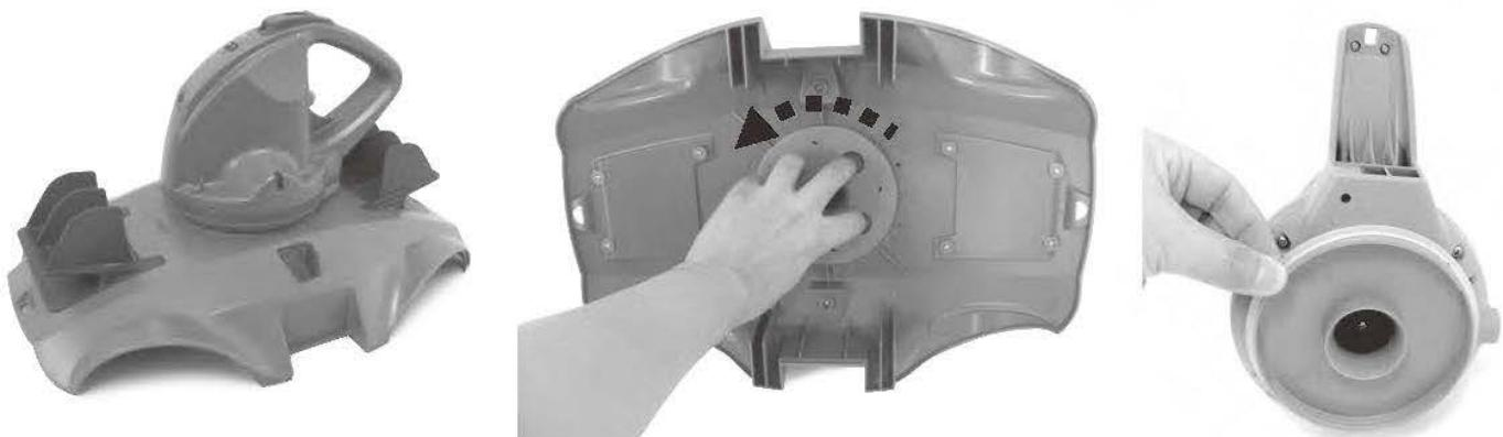
2. Con un cacciavite rimuovere le 4 viti nella parte inferiore della testina, in modo da smontare la piastra alla base. Svitare col cacciavite tutte le viti della base come indicato in figura. Rimuovere la girante, fare leva sulla piastra e rimuoverla, quindi scoprire l'interno.
