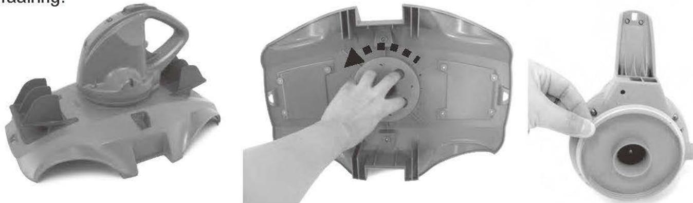
2. Draai de 4 schroeven op de onderkant van de draaikop los met de schroevendraaier om de onderste plaat eerst los te maken. Gebruik de schroevendraaier om alle schroeven op de basis los te schroeven zoals op de afbeelding. Verwijder de waaier en wruk dan de basis los en verwijder hem zodat u bij de kop kunt komen.
