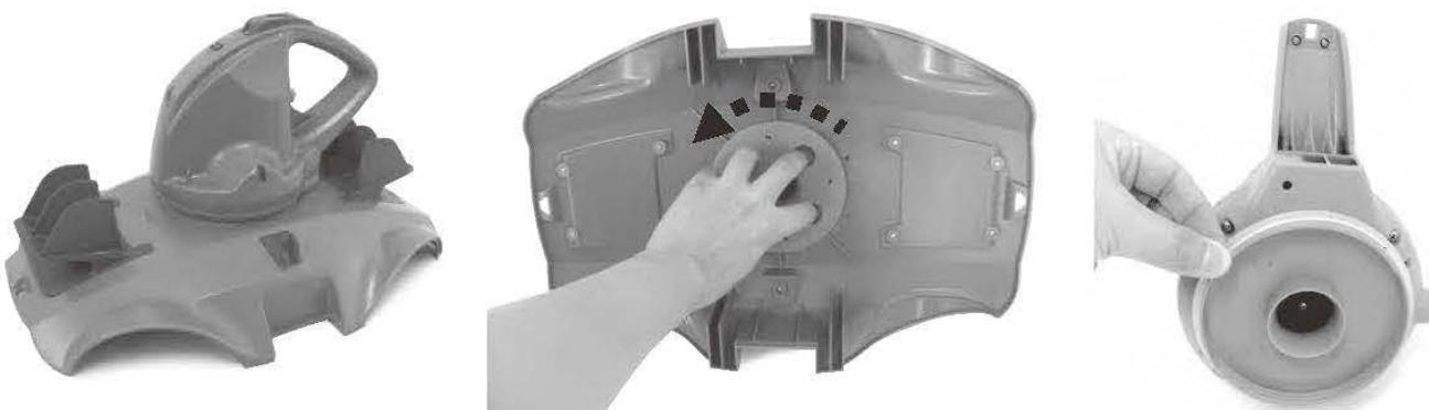
2. Use el destornillador para aflojar los 4 tornillos presentes en la parte inferior del cabezal, para soltar en primer lugar la placa inferior. Use el destornillador para aflojar todos los tornillos de la base, como se ve en la figura. Retire el impulsor y luego haga palanca en la base y retírela para dejar a la vista el interior del cabezal.
